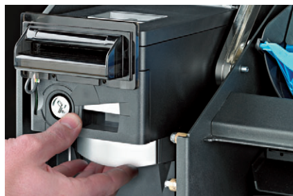
Mécanisme pour le déblocage de la cassette
